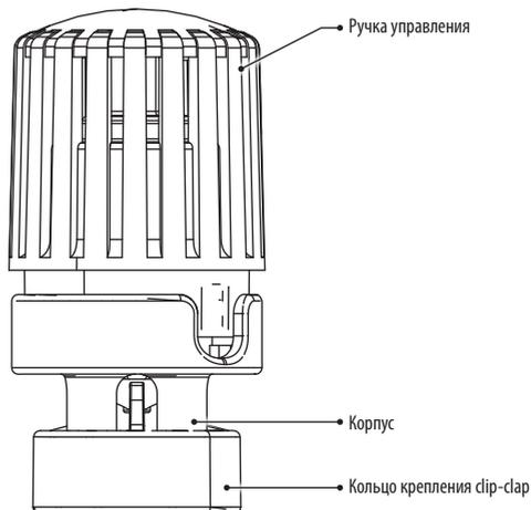
Головка термостатическая с быстрьюемным CLIP-CLAP креплением к клапану
